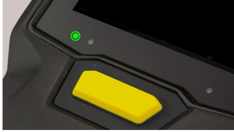
LED şarj durumu göstergesi bekleme modunda.
