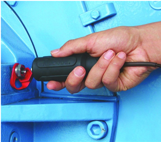
VIBCODE sensörünü VIBCODE ölçüm konumuna bağlayın.
