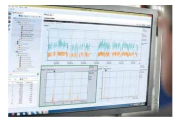
O VibGuard IIoT envia medições para o software OmniTrend Center, onde as equipes podem visualizar, avaliar, apresentar tendências e armazenar todos os dados recebidos. É compatível com interfaces Ethernet (TCP/IP), Modbus (TCP/RTU) e MQTT.
